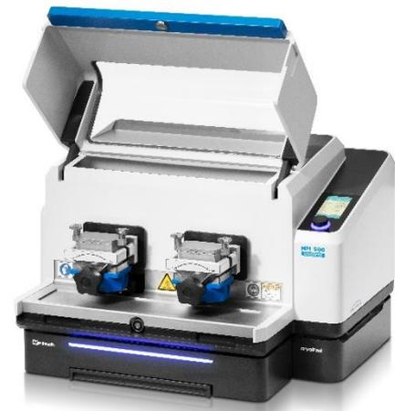
Il Vibro Mulino a Sfere Retsch MM 500 Control, permette la macinazione di un'ampio range di matrici a secco, ad umido e Cryogenicamente, con la possibilità di lavorare a temperatura controllata con una frequenza di oscillazione fino a 30 Hz.
