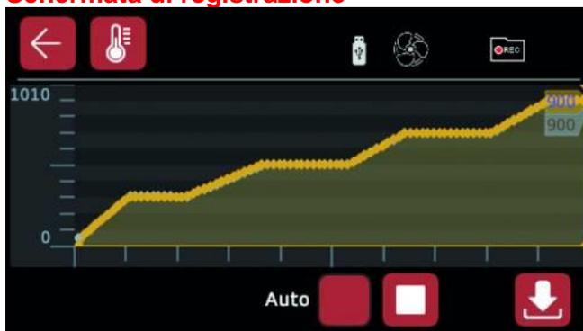
La schermata datalogging mostra una vista grafica della temperatura di setpoint e attuale con anche lo stato di ogni relay configurato. La registrazione avviene su di un supporto USB in formato .csv. Il datalogging può essere attivato o manualmente o in automatico quando un programma è in svolgimento.
