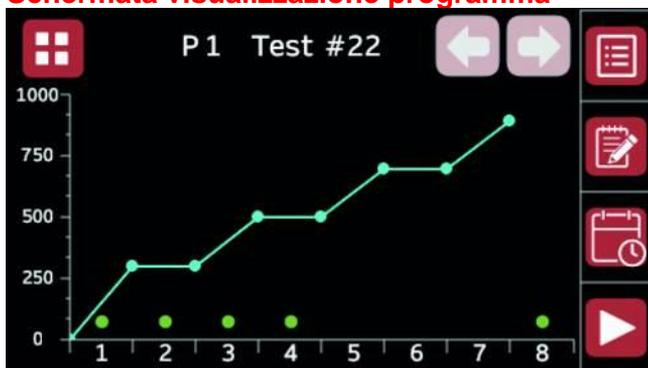
La schermata di visualizzazione del programma mostra un riepilogo grafico del programma selezionato. Fornisce inoltre l'accesso a: Selezione del programma; creazione e modifica di un programma; pianificazione di un programma per iniziare ad una determinata ora e data e l'avvio di un programma.
