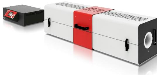
Forno tubolare apribile a singola zona TS1 12/125/1200 con posizionamento orizzontale e controller CC-T1 in modulo separato.
